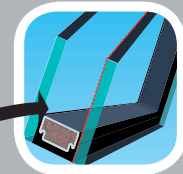
VIDRIO TERMOAISLANTE U3 - Vidrio exterior templado, vidrio interior flotado con capa de baja emisividad, ensamblados en un marco aislante TGI. Cámara rellena de gas argón.
